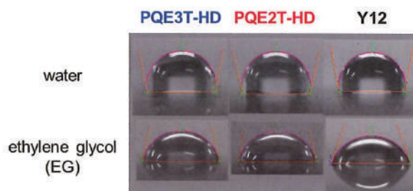
図-8 PQE2T-HD, PQE3T-HD および Y12 薄膜の水およびエチレングリコールに対する接触角
