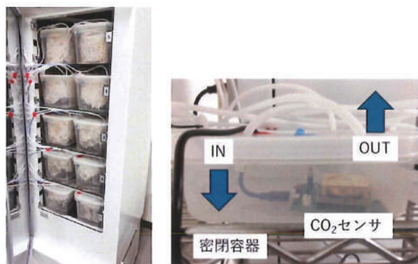
(a) 恒温室と菌床 (b) 二酸化炭素収支計測装置 図-2 二酸化炭素収支計測装置
