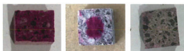
(a) 炭酸化なし (b) 2.3mm 炭酸化 (c) 完全に炭酸化 図-8 試験に用いたモルタル小片の炭酸化深さ
