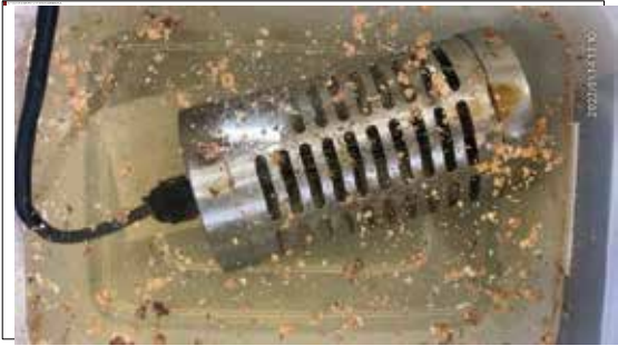
図 3.6 電極表面洗浄中のオゾン水発生器
