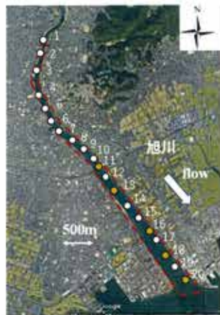
図-6 水質の縦断計測地点 (地点1は河口より7.6km)
