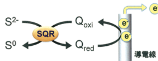
図 2. SQR 負電極の概略図
