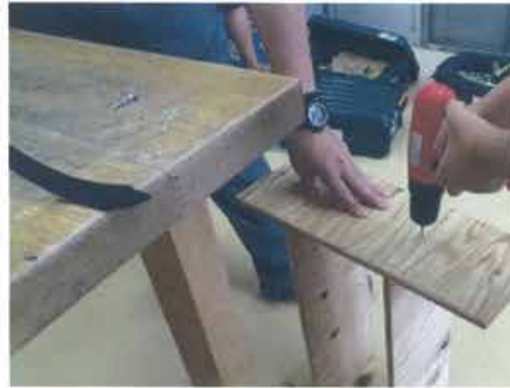
電気ドリルによる下穴開け
