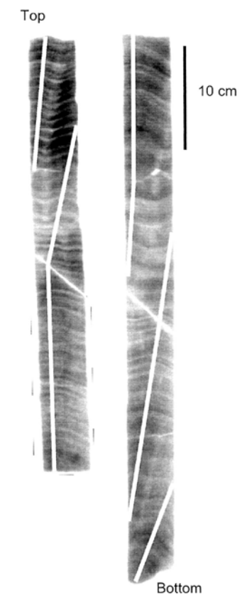
図 2 骨格断面の X 線写真 色の濃淡は密度の違いを表している。黄色の線はサンゴの成長軸を示しており、この軸にそって粉末試料の採取を行っている。
