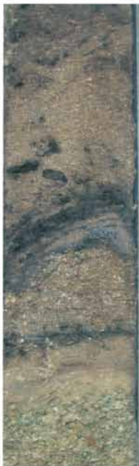
図4 -33.5mの植物片による葉理を挟む。砂は石英と長石からなる。横6cm
