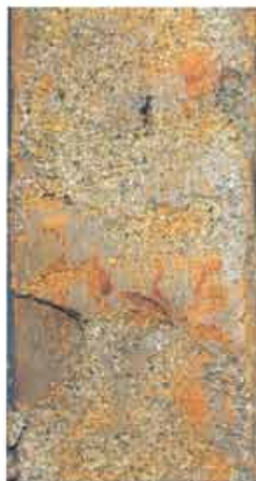
図5 標高-0.7m 付近の砂層。泥岩ホルンフェルスなど多様な砂粒からなる。横 6cm
