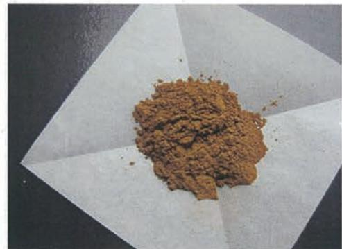
Fig. 4 乾燥スラッジを 450℃で 24 時間熱処理した熱処理スラッジ
