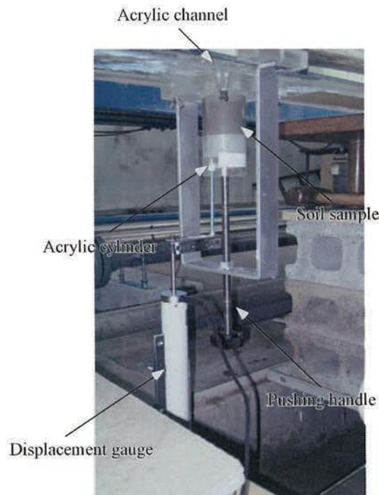
図3 開水路に土供試体を取り付けた様子（開水路の下方から撮影）
