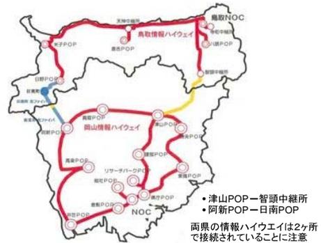
図 5 鳥取県との情報ハイウェイの接続
