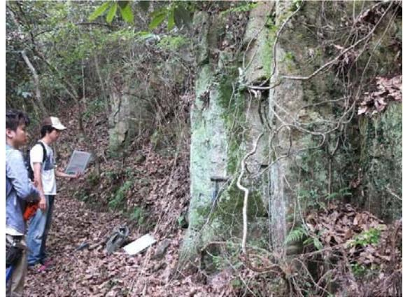
図4 屏風岩麓の露岩：垂直な節理が明瞭
