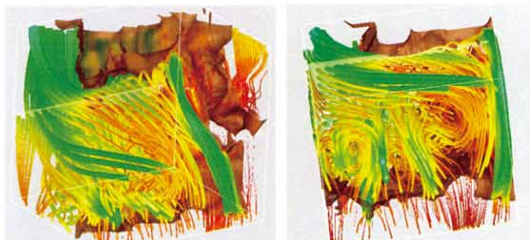
図3 間隙内流線図（左図：側面から見た流れの様相、右図：下面から見た流れの様相）
