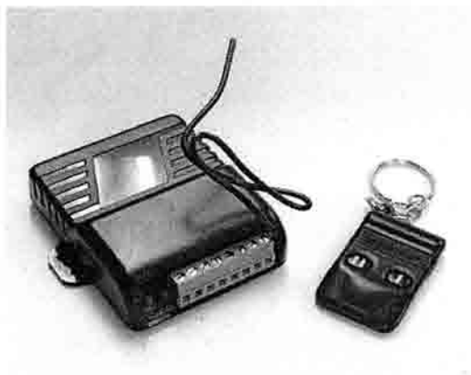
図3. リモコン送受信機: (右) 送信機, (左) 受信機
