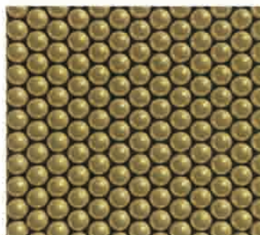
図1：多数のナノギャップを有する最密充填配列構造
