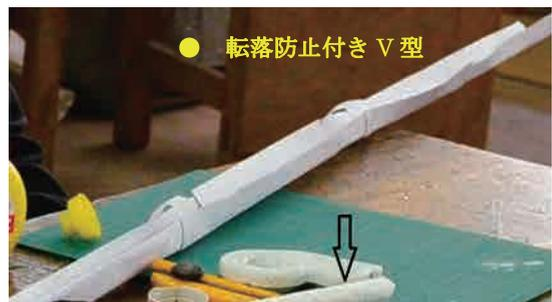
上の写真で 転落防止付きというのは、長いV型では、重みでV型が開くように折れ曲がり傾いて乾電池が落下する。V型が開くのを防ぐ仕組みである。それでもアーチ形が横に引かれるので、改良の余地がある。
