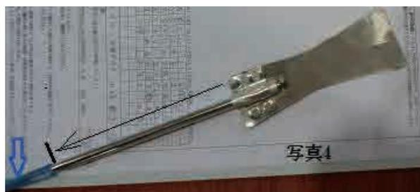
携帯ラジオのポールアンテナは入手困難。自動車の前端を示すポールが丈夫で種類も多いので、指導者が提供した。へらの部分は自作して、ポールの先端飾り（青色矢印で示す）を残し、黒色矢印のようにスライドする写真4の仕組みにした。
