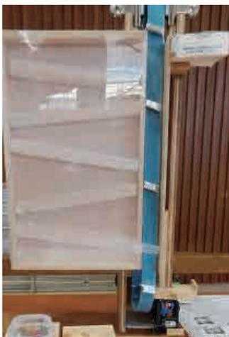
ゲーム機と言っているのは、写真左の箱の中の樋転がり落とした鉄球と、動き続けているベルト上のバケットの位置が下方で揃うと、球を回収できる。いくつ回収できるかを競うゲームにしようということにして、ゲーム機が誕生した。
