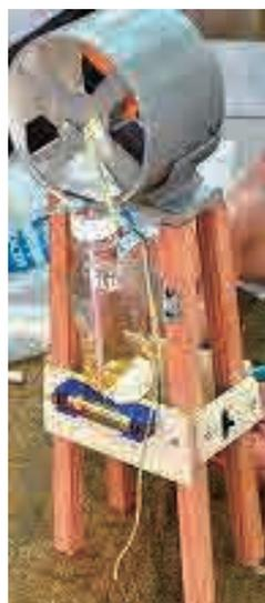
机上扇風機を作ると決まった。3Vで使うマブチのモーターを4本足の台に載せた形が完成イメージである。工作してみると、足の長さを揃えてぐらぐらしない台を作ることは大変むづかしいことに気づいた。しかし、作り直す勇気さえあれば新しい工作方法にたどり着くものである。
