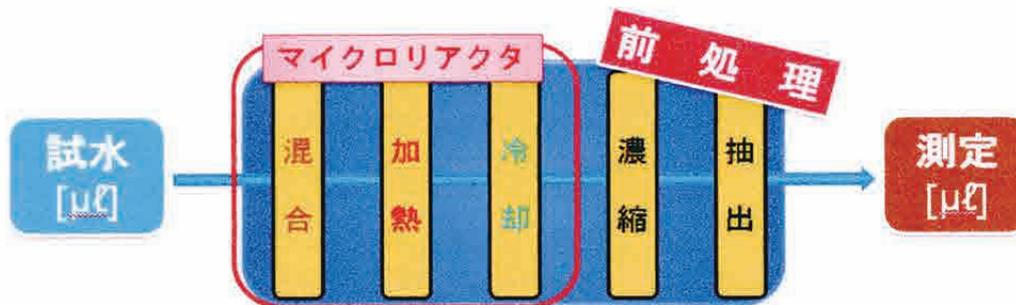
図2 水質分析の前処理工程にマイクロリアクターを用いる場合
