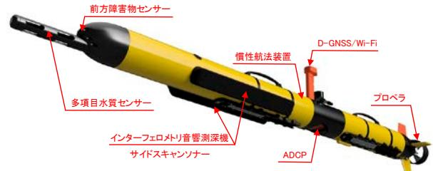
自立型無人潜水機AUV
