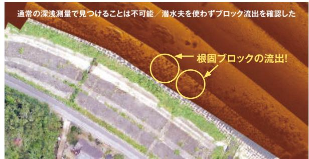
河川構造物の点検(根固ブロックの流出状況の音響画像)
